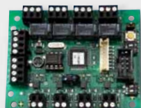
Anschluss nicht busfähiger Komponenten per extra I/O-Modul
