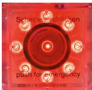
Türzustand: verriegelt, rot leuchtend
