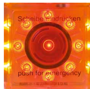
Türzustand: Sabotageversuch, rot/gelb blinkend
