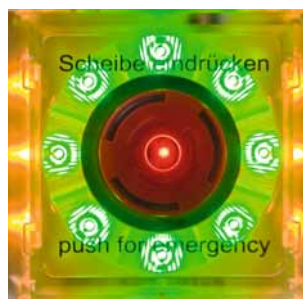
Türzustand: Freischaltung/Notentriegelung, grün/gelb blinkend
